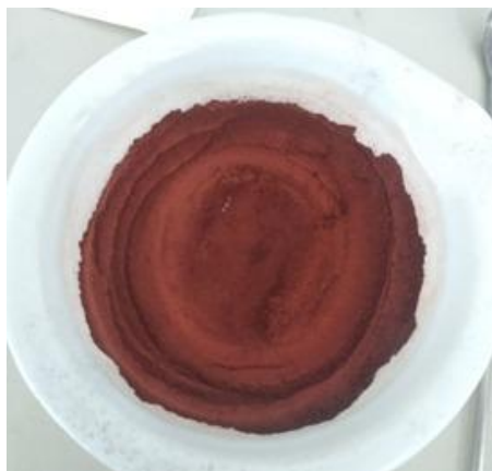
Gambar 1. Hematit ( \alpha\text{-Fe}_2\text{O}_3 ) yang telah disintesis dari pasir besi
